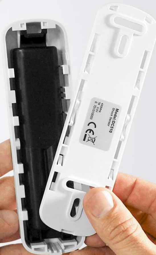
La base sirve para cubrir y proteger los componentes del sensor.
